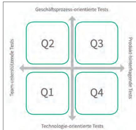
**Testquadranten:** Mit diesem Konzept kann das Team überprüfen, ob es alle wichtigen Testarten auf den dazu passenden Teststufen durch Testfälle berücksichtigt hat (Bild 1)
