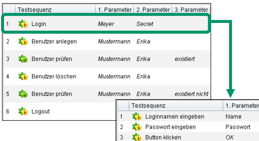
Abb.1: Loginprozedur abgebildet über zusammengesetzte Schlüsselworte auf zwei Ebenen am Beispiel des Werkzeugs TestBench.
